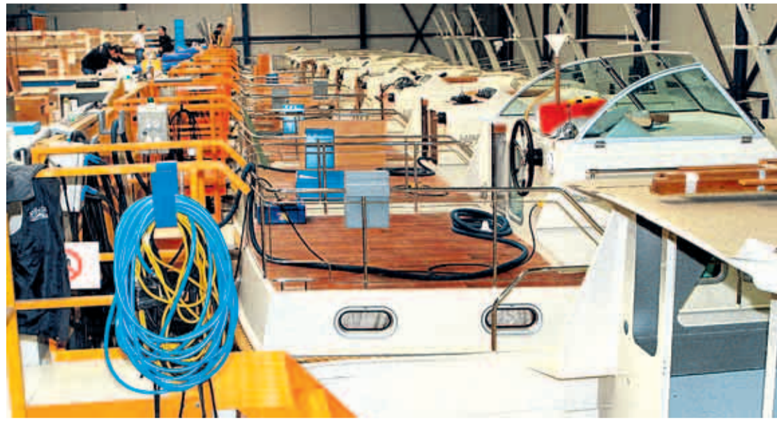
In der Werft wurde vergangenen Herbst Fließbandproduktion eingeführt, was die Bauzeit erheblich verkürzt
